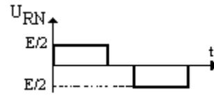
Fig.4. La forme d'onde pour onduleur à deux niveaux.
