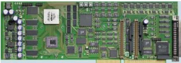
Fig. 1: DS1103 controller board
