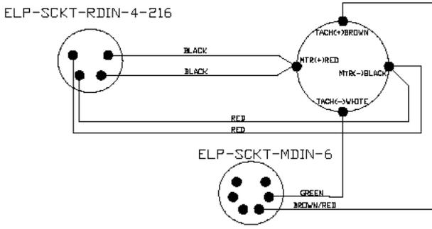
Fig. 4 Tachometer wiring
