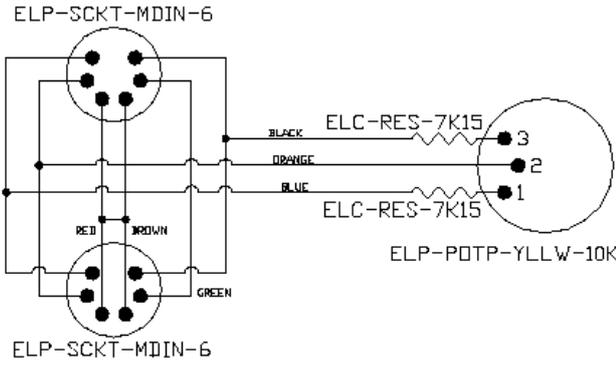
Fig. 5. Potentiometer wiring
